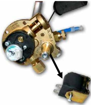
Solo sui serbatoi toroidali con multivalvola interna, per agevolare il montaggio della multivalvola si deve smontare l'elettrovalvola, svitando la vite in testa alla stessa.
